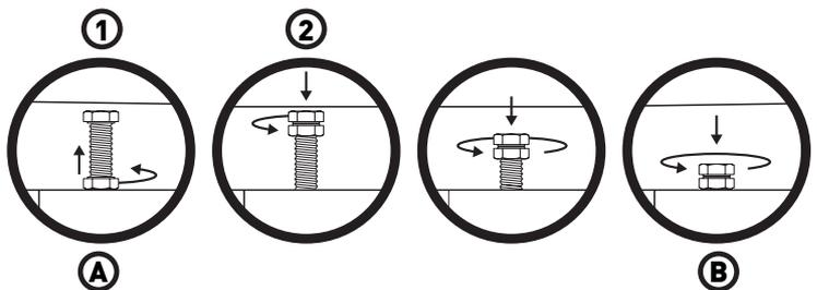
1. Lösen Sie die unteren Muttern der vier Verriegelungsschrauben.
