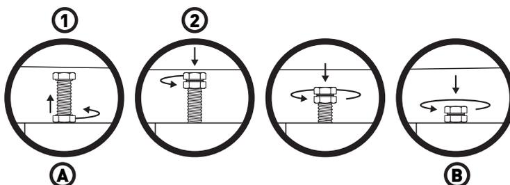
1. Aflojar las tuercas inferiores de los 4 tornillos de bloqueo.
