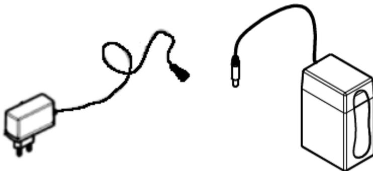
Es conveniente recargar ambas baterías al mismo tiempo: El sistema se desconectará de forma automática cuando se agote la batería con menos carga.
