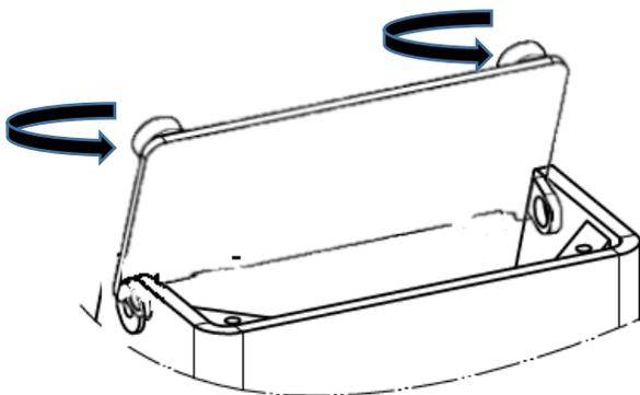
Extraiga la batería recargable de cada horquilla y conéctela a cualquiera de los dos cargadores suministrados. Enchufe el cargador a una toma de corriente de 220V/50Hz.
