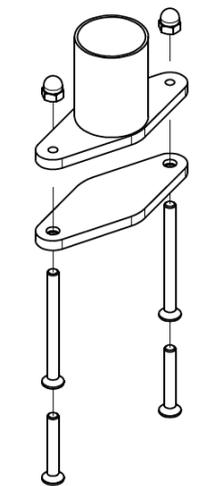
Atornille con firmeza la mordaza de sujeción a una de las barras de la cabina de la carretilla elevadora en la posición que crea más conveniente. En el embalaje encontrará tornillos M6 de dos largos distintos, 40mm y 70mm.
